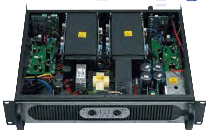
Vue interne du SMi1500 avec un aperçu de l'alimentation à découpage.
