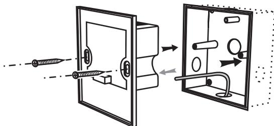
5 - Coloque el panel frontal teniendo cuidado de no dañar el conector de múltiples clavijas.
