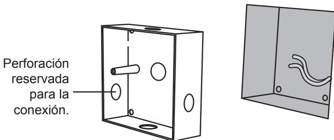
2 - Asegure la caja de montaje con los tacos adecuados para el soporte.
