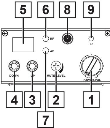
**A1** - Fader de control de volumen para el módulo de alta frecuencia (UHF). De apagado a potencia máxima (de izquierda a derecha).
