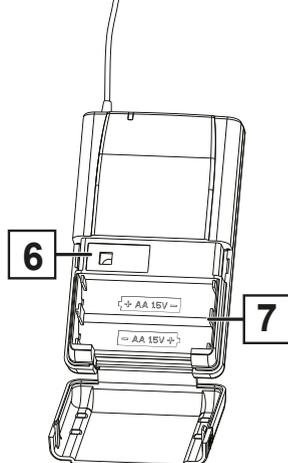
6 - Sincronización del diodo IR. La función ASC (conexión de sincronización automática) le permite sincronizar un canal seleccionado entre el micrófono transmisor y el receptor a través de la transmisión por infrarrojos. Para hacerlo, seleccione un canal (del 1 al 16) en el receptor. Pulse el botón ASC y coloque el diodo IR de su micrófono frente al diodo IR (#9) del receptor
