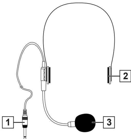
1 - Conector para enchufar el transmisor de bolsillo. Enchufe el micrófono de diadema con el conector #1 del transmisor.
