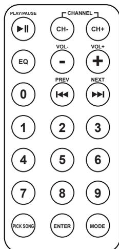
El mandos a distancia por infrarrojos de su lector le permite controlar de forma remota algunas funciones para sus fuentes SD/USB o Bluetooth®. Los botones CH- y CH + están desactivados en este dispositivo.
