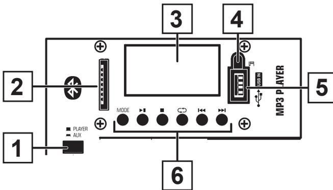
**B1** - Selector de entrada del canal 1. Le permite decidir si el reproductor o la entrada auxiliar estarán activos en el canal 1 del mezclador.
