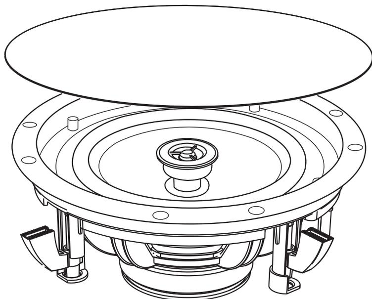
Deckeneinbau-Lautsprecher für 8-Ohm-Verstärker. Lautsprecher mit zwei Frequenzbereichen. Unsichtbare Kantengestaltung mit Magnetgitter.
